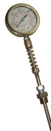
Pirometro in acciaio inox, cassa stagna, quadrante diam. 80-100 mm a carica di mercurio, bulbo posteriore rigido lunghezza a piacere, raccordo da  $3/8'' - 1/2'' - 3/4''$ , scorrevole autobloccante. Grad. 0 +600 °C e Fh
