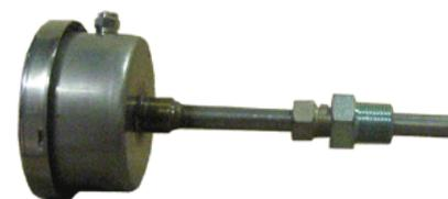
Pirometro cassa in acciaio inox stagna, a distanza con capillare flessibile lunghezza a piacere, quadrante diam. 80-100-130-150 mm a carica di mercurio, raccordo da  $3/8'' - 1/2'' - 3/4''$  femmina girevole scorrevole. Grad. 0 +600 °C e Fh
